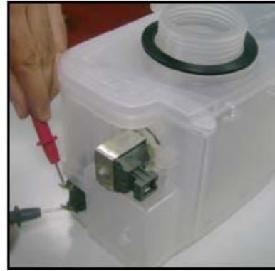
0 Ω (sans sel) et ∞ Ω (avec sel)
