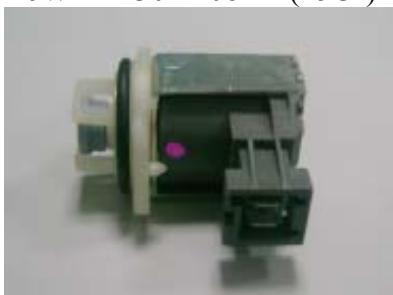
Electrovanne régénération 6W - 4130 ±10ohm (25C°)
