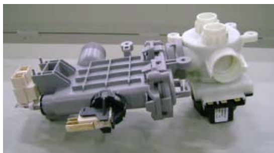
Groupe résistance avec distributeur 8W – 6840 \pm 5 ohm
