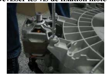
Dévisser les vis de fixation moteur
