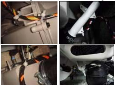
Enlever les clips de fixation amortisseur
