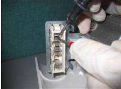
Mesure tachymètre (TAKO)
