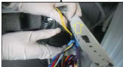
Démonter le pressostat EPS
