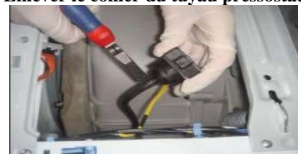
Enlever le collier du tuyau pressostat
