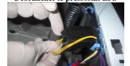
Débrancher le pressostat EPS
