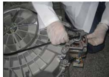
Dévisser les vis de fixation moteur
