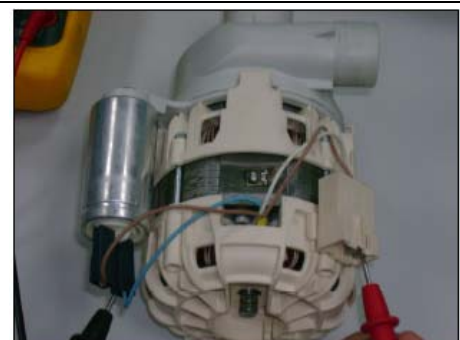
Mesure enroulement secondaire (câble bleu) 126 +/- 7
