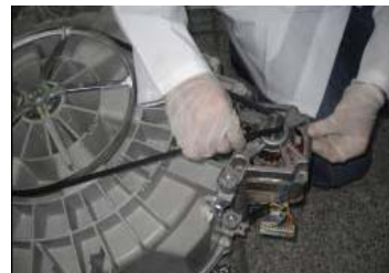
Dévisser les vis de fixation moteur
