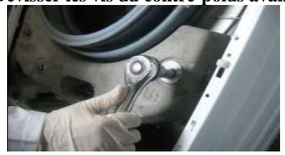
Dévisser l'écrou central fixation résistance (8mm)
