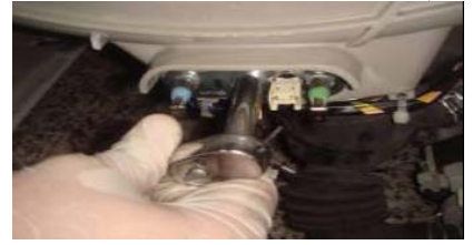
Démonter le collier joint de hublot
