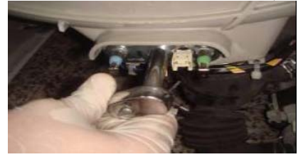
Démontez le collier joint de hublot
