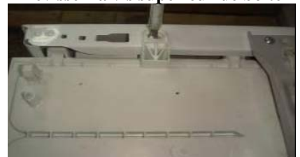
Démonter les 2 vis de l'anti-parasite
