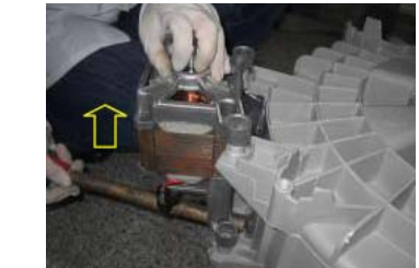
Démonter le moteur
