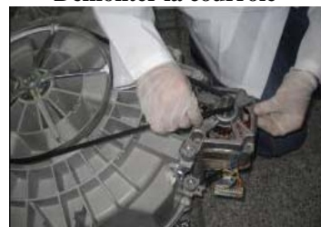
Dévisser les vis de fixation moteur
