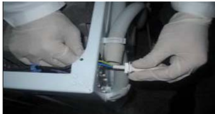
Démonter le pressostat EPS
