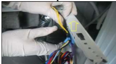
Démonter le pressostat EPS
