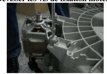
Dévisser les vis de fixation moteur
