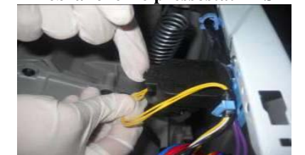
Débrancher le pressostat EPS
