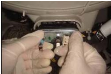
Dévisser les vis du contre-poids supérieur
