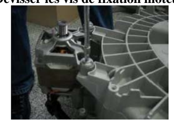
Dévisser les vis de fixation moteur
