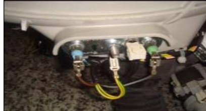
Démontez le collier joint/cuve
