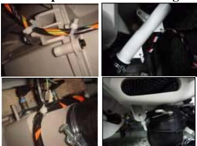
Enlever les clips de fixation amortisseur
