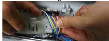
Débrancher le câblage
