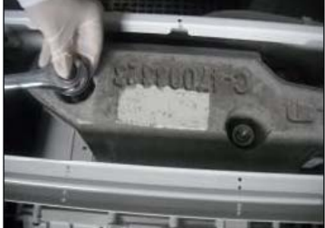
Couper les fixations câblage
