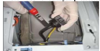
Enlever le collier du tuyau pressostat
