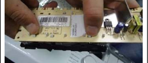
Appuyer sur les clips pour enlever l'ensemble touches
