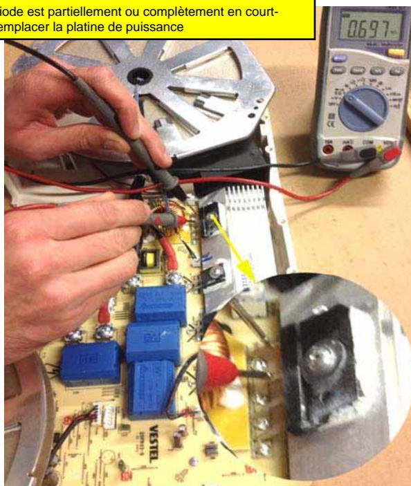
Si un des triacs est en court-circuit, il faut remplacer la platine de puissance
